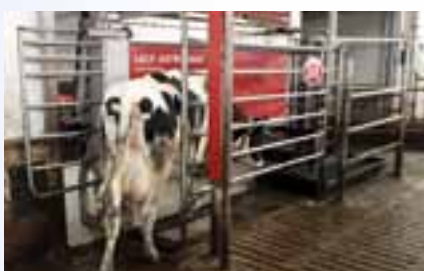
Konstrukcja robota ASTRONAUT A4 pozwala na swobodne na wprost wchodzenie i wychodzenie krowy z boksu. (fot. P. Wiczorek)
